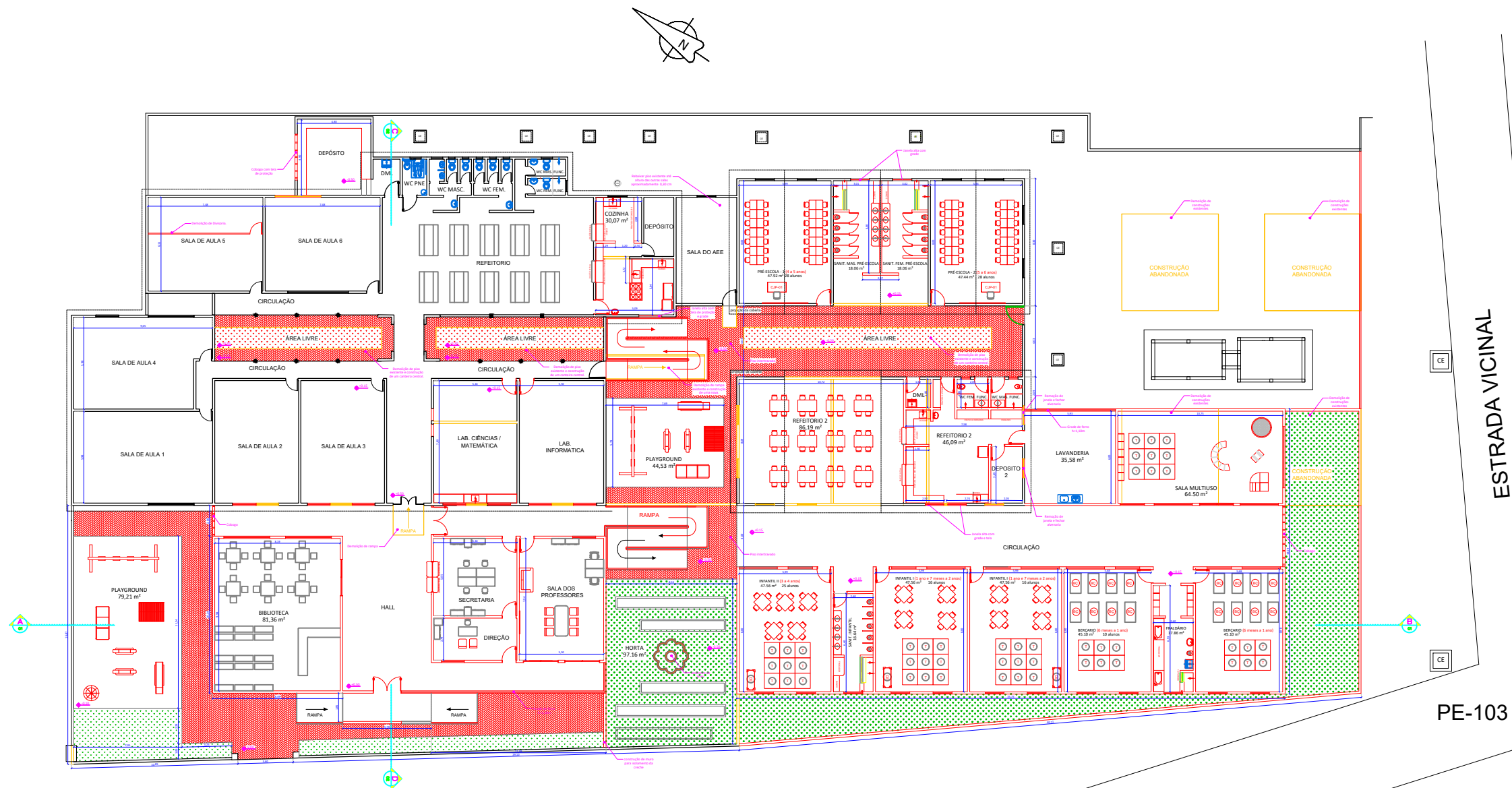
2 PLANTA BAIXA - REFORMA E DEMOLIÇÃO ESCALA: 1/250
